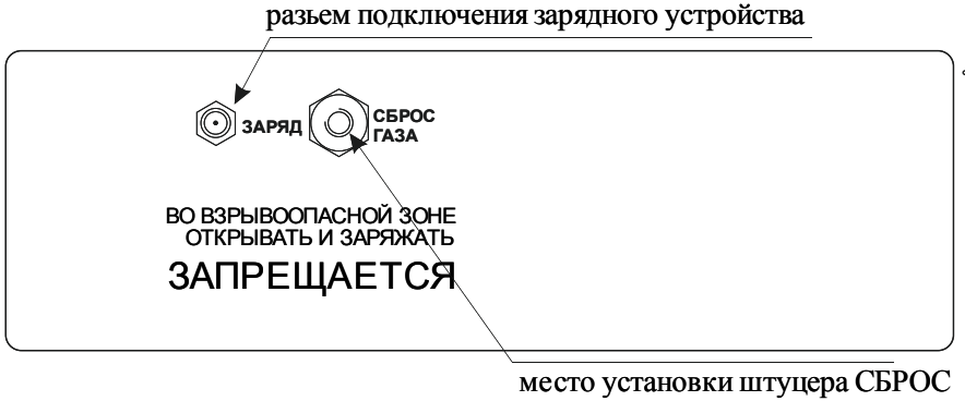
Рис. 2. Передняя (а) и задняя (б) панель газоанализатора
