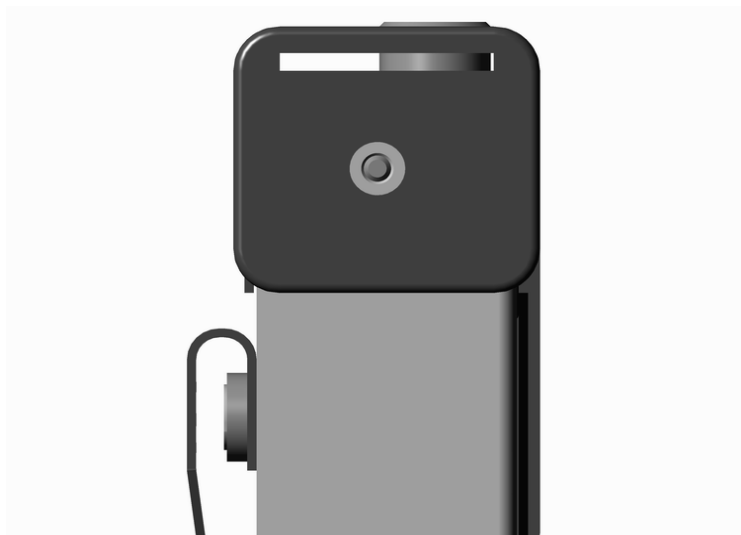
Рис.4. Расположение гайки, закрывающей доступ к регулировочным потенциометрам
